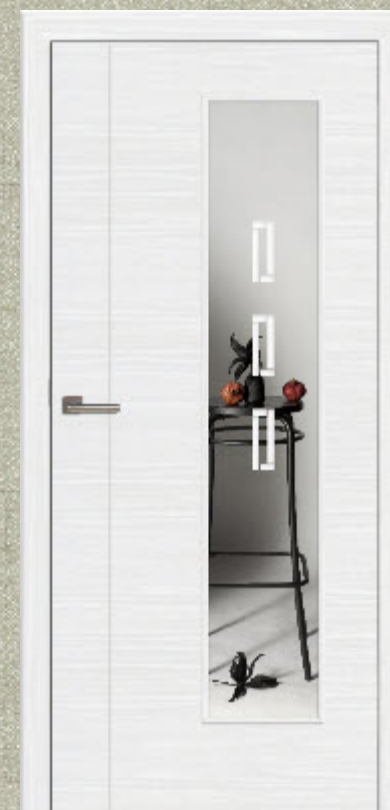
Türelement Florenz cE19 SE stumpf einschlagend Designleisten 8 mm matt Lichtausschnitt LV bandseitig, Glas Rubin 051 Rosettengarnitur Viona Quadro OF 60 (ohne Schlüssellochbohrung) 3-D-Bandteile verdeckt, Zarge Sinus SE
